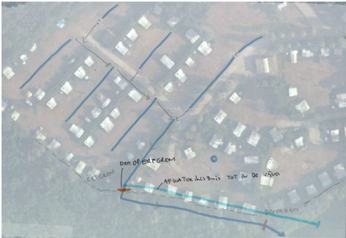
Figuur 3. Het voorstel van Rho Adviseurs BV om via een ondergrondse buis de afvoer van kwel- en regenwater richting het meertje te garanderen. Daarbij wordt de duiker die het water tot voor kort afvoerde naar de naast het recreatieterrein gelegen sloot opgeheven (Bron: Justus van den Berg, Rho Adviseurs BV). Onderkant is noord.
