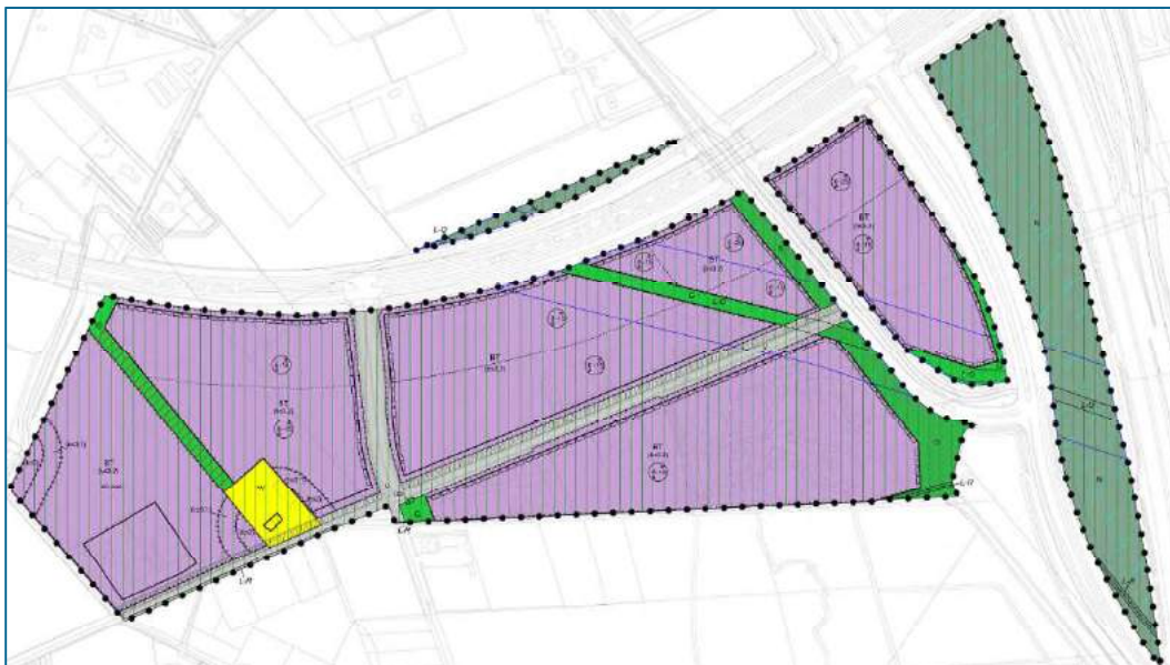
Figuur 3.2: Detail van het plangebied. De groene strook met de blauwe flankerende lijnen: hier liggen de buisleidingen.
