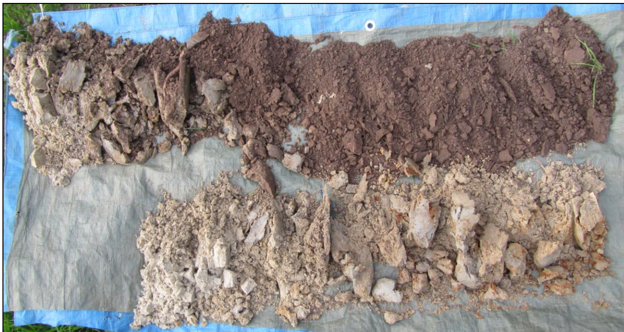
Figuur 6: Boring 5 uitgelegd van rechtsboven naar linksonder.
