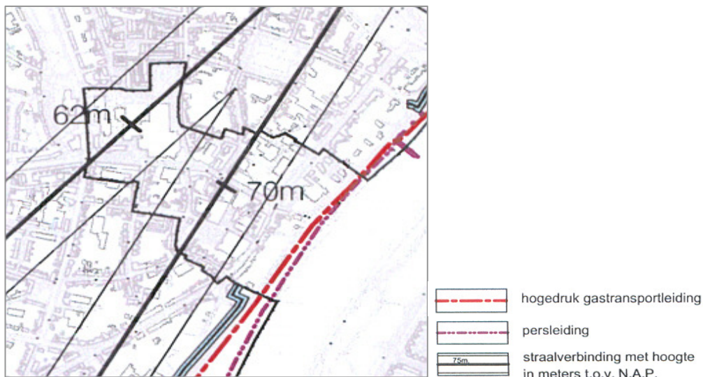
Ligging kabels, leidingen en straalpaden
