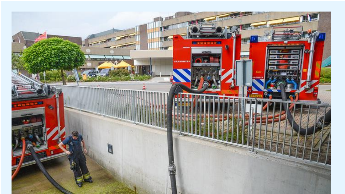
figuur 7a: tankautospuiten maken gebruik van open water als waterwinplaats
