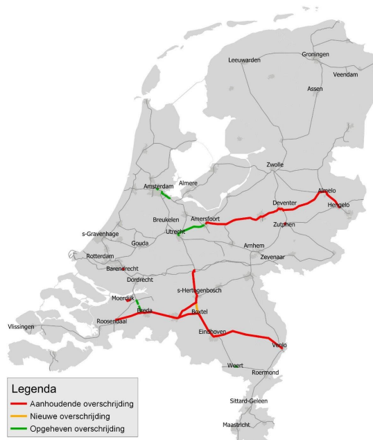
Figuur 3: vergelijking overschrijdingen PR-10 -7 -risicoplafonds in 2020 t.o.v. 2019
