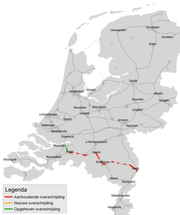
Figuur 2: vergelijking overschrijdingen PR-10 -6 -risicoplafonds in 2020 t.o.v. 2019
