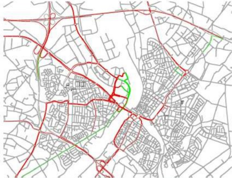
Afbeelding 3 Verschilplot Plansituatie 2030 t.o.v. Autonome Situatie 2030 (rood = toename van verkeer en groen = afname van verkeer)
