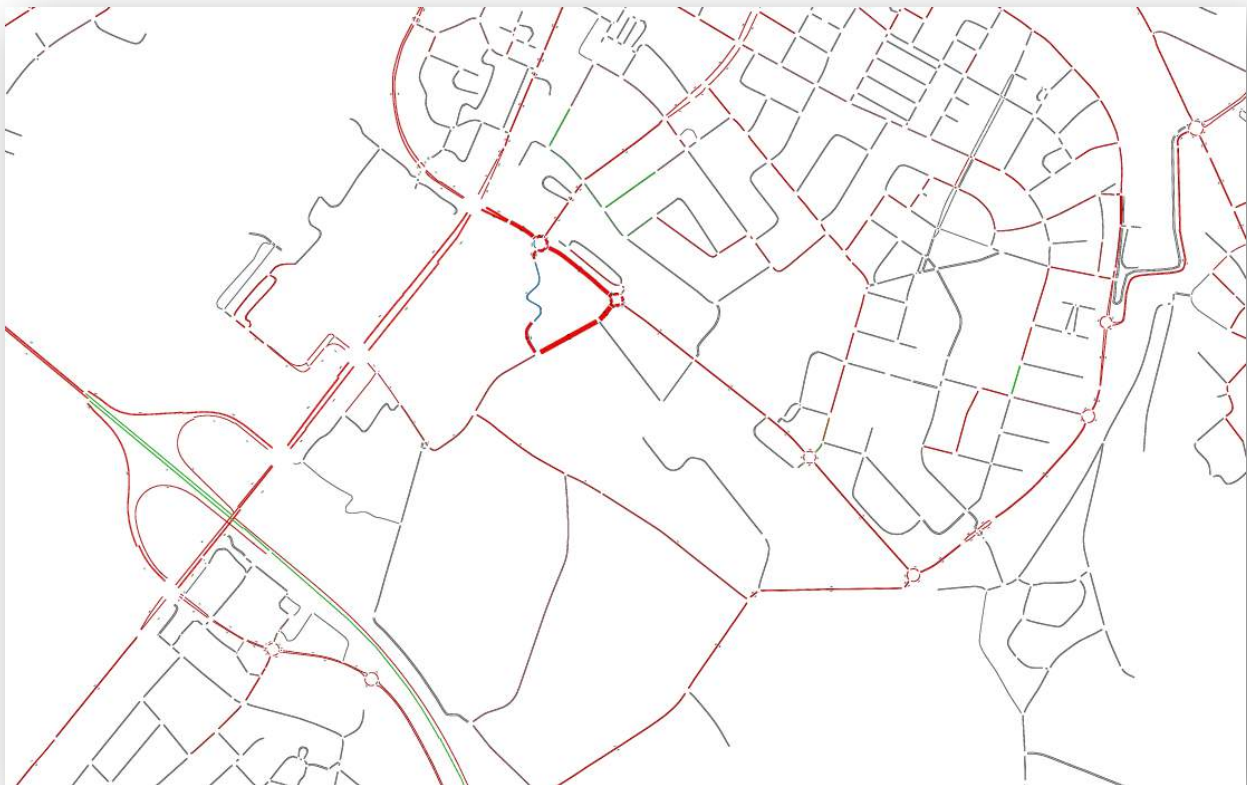
Afbeelding 2 Verschilplot Variant Veilingterrein 2040 Hoog t.o.v. Prognosejaar 2040 Hoog (herkalibratie) Rood = toename van verkeer / groen is afname van verkeer. In bijlage 3 is de plot beter zichtbaar.
