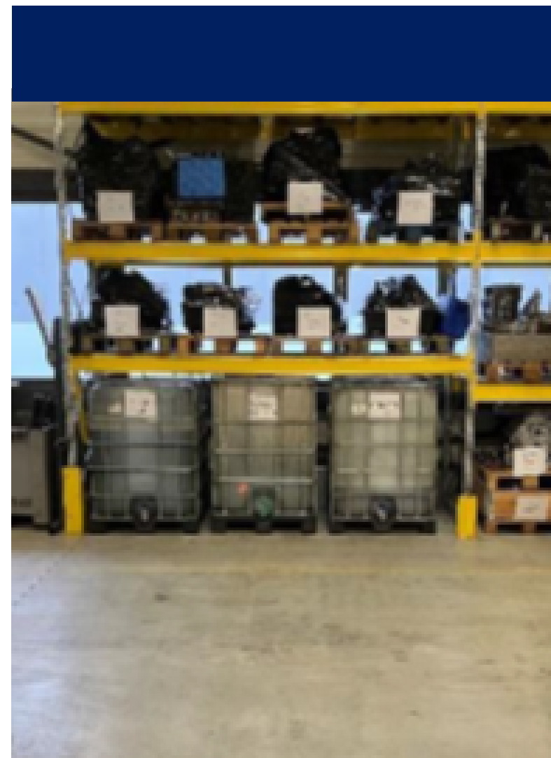
Opslag gevaarlijke stoffen zonder lekbak
