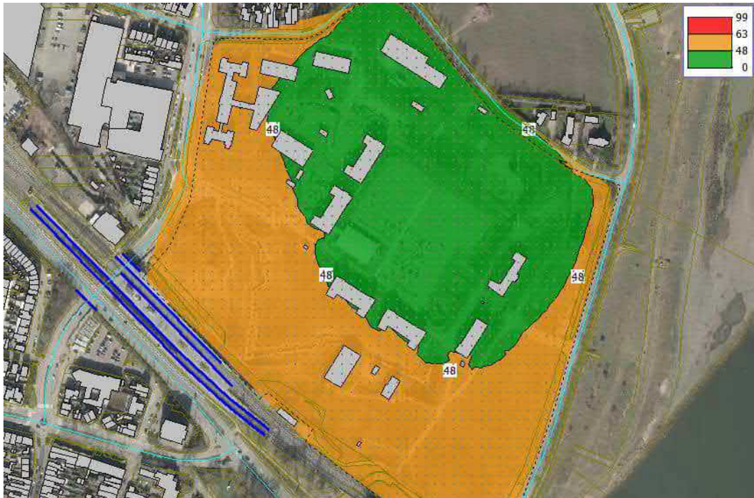
Afbeelding 7 Gecumuleerde geluidbelastingen alle wegen (rekenhoogte 10 meter).
