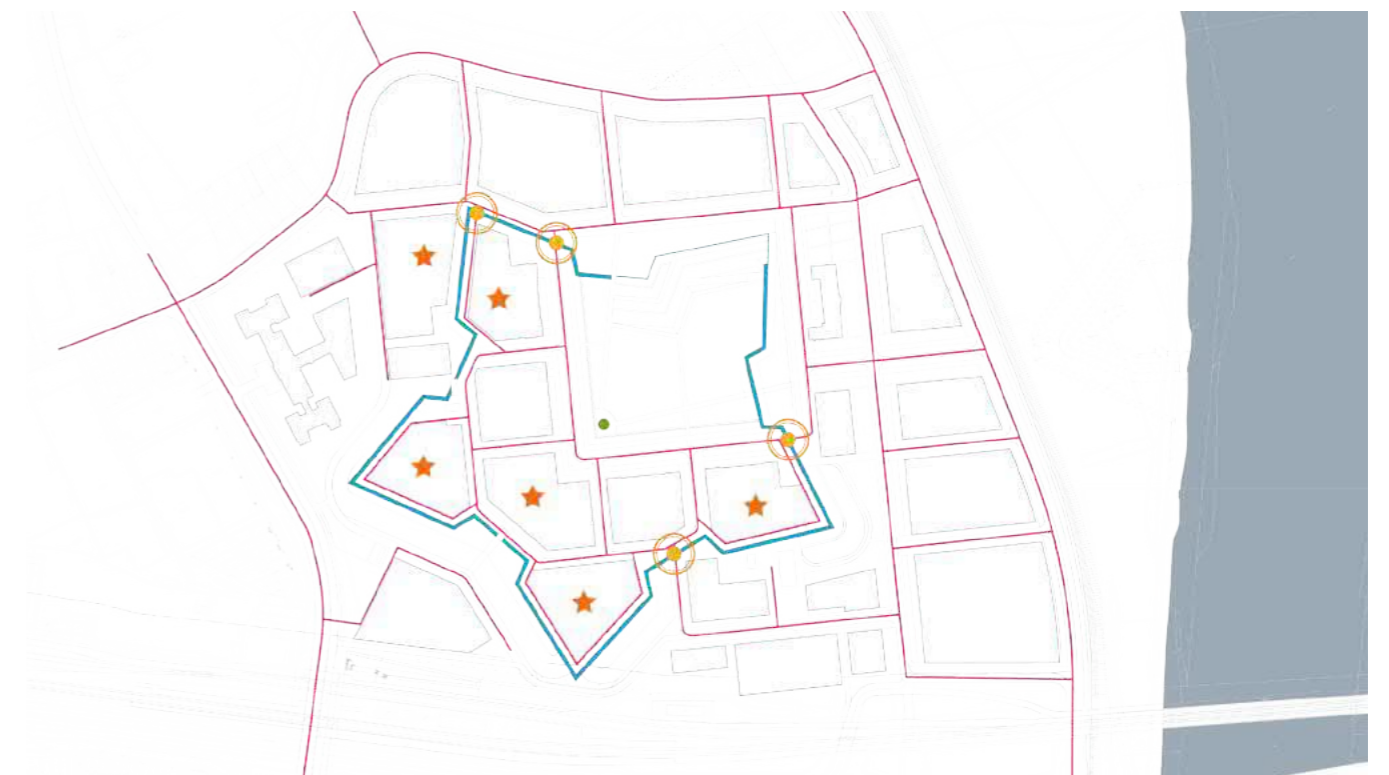
principe kabels & leidingen bij de fundamenteën fort Sint-Michiel
