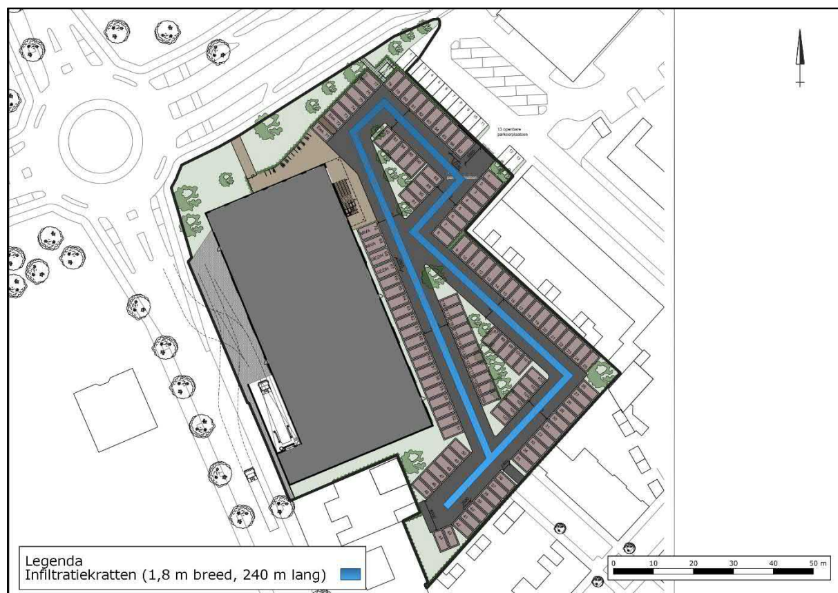
Figuur 9: Situering infiltratiekratten
