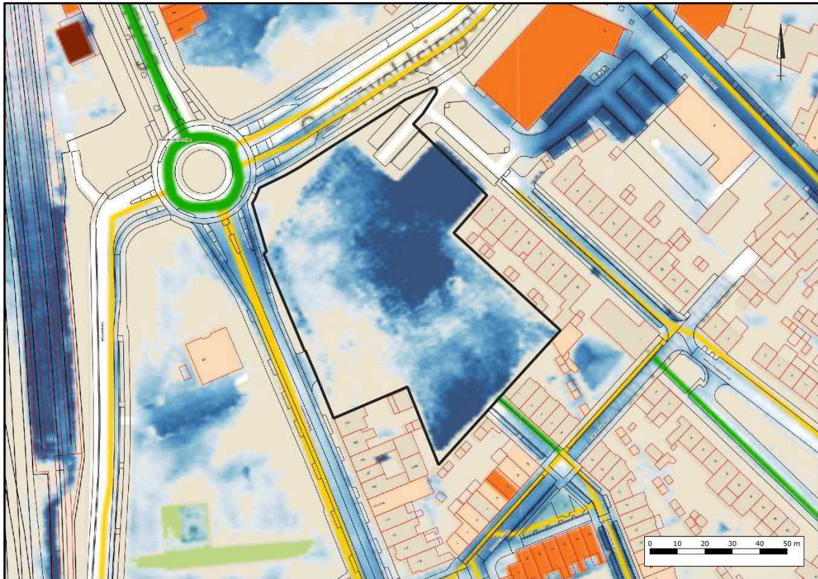
Figuur 4. Stresstest T=100 jaar, bui 60 mm in 1 uur (bron: https://wpn.klimaatatlas.net/ )
