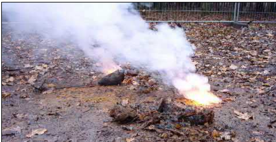
Afbeelding 20: Het opbranden van witte fosfor uit een opengebroken OO.
