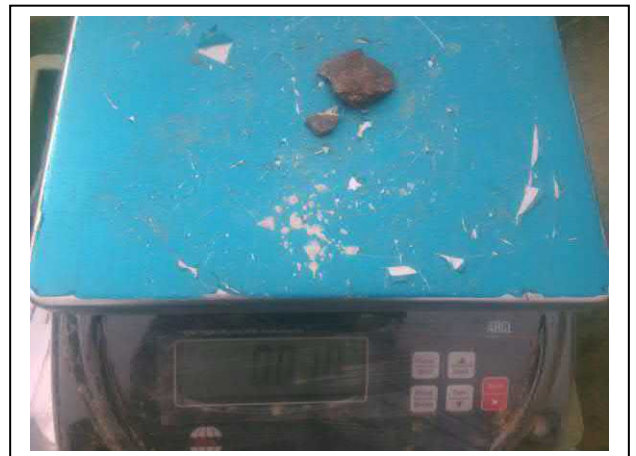
Foto 12. Asbestverdacht materiaal gat D14/C10
