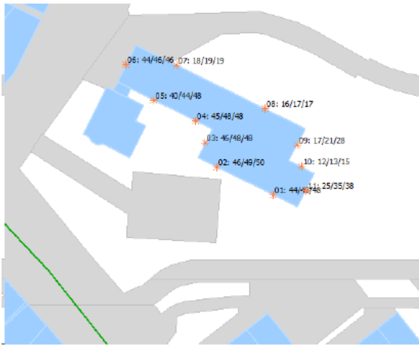
Geluidbelasting ten gevolge van de Leutherweg per gevelzijde en per bouwlaag na aftrek van 5 dB conform art. 110g Wgh.
