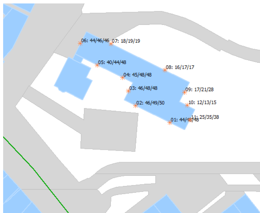
Figuur 4: Geluidbelasting ten gevolge van de Leutherweg per gevelzijde en per bouwlaag na aftrek van 5 dB conform art. 110 Wgh.
