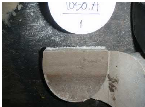
Foto 12: In het zaagvlak (bovenzijde) zijn de lichtgekleurde asbestvezels goed zichtbaar.
