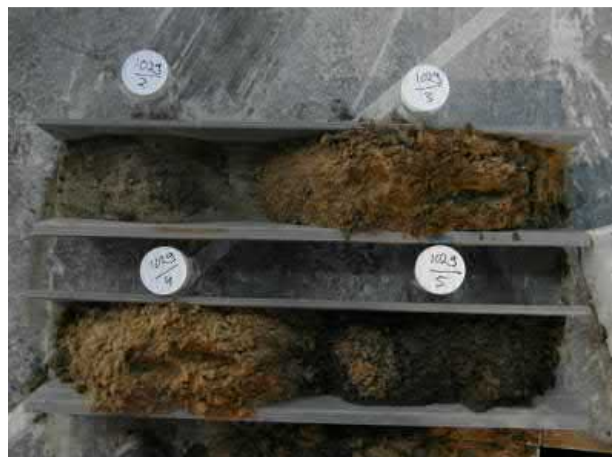
Foto 6: Als gevolg van ophoging ligt het oude maaiveld op \pm 1,5 m-mv (1029-5). Deze oude donkere bovengrond wordt in veel boringen aangetroffen.
