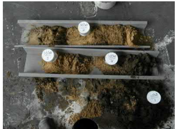
Foto 10: De metaalslakken in 1030-1 veroorzaken een Zink-koperverontreiniging > Iw in monster M20.
