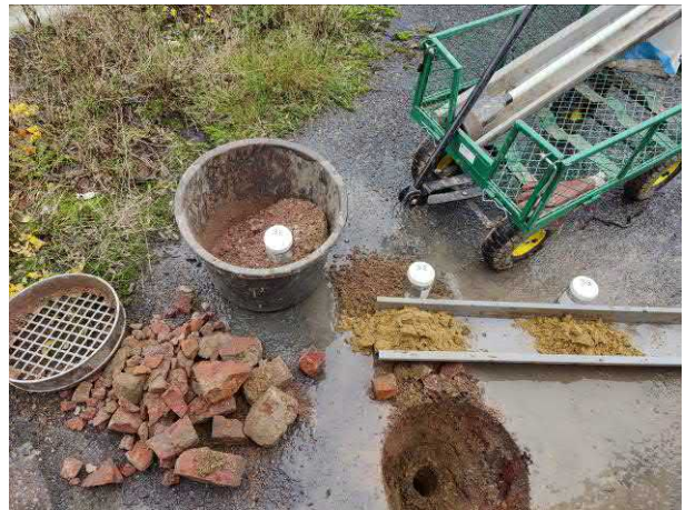
Foto 4: Voorbeeld van baksteenfundering onder asfalt en zand in de ondergrond.
