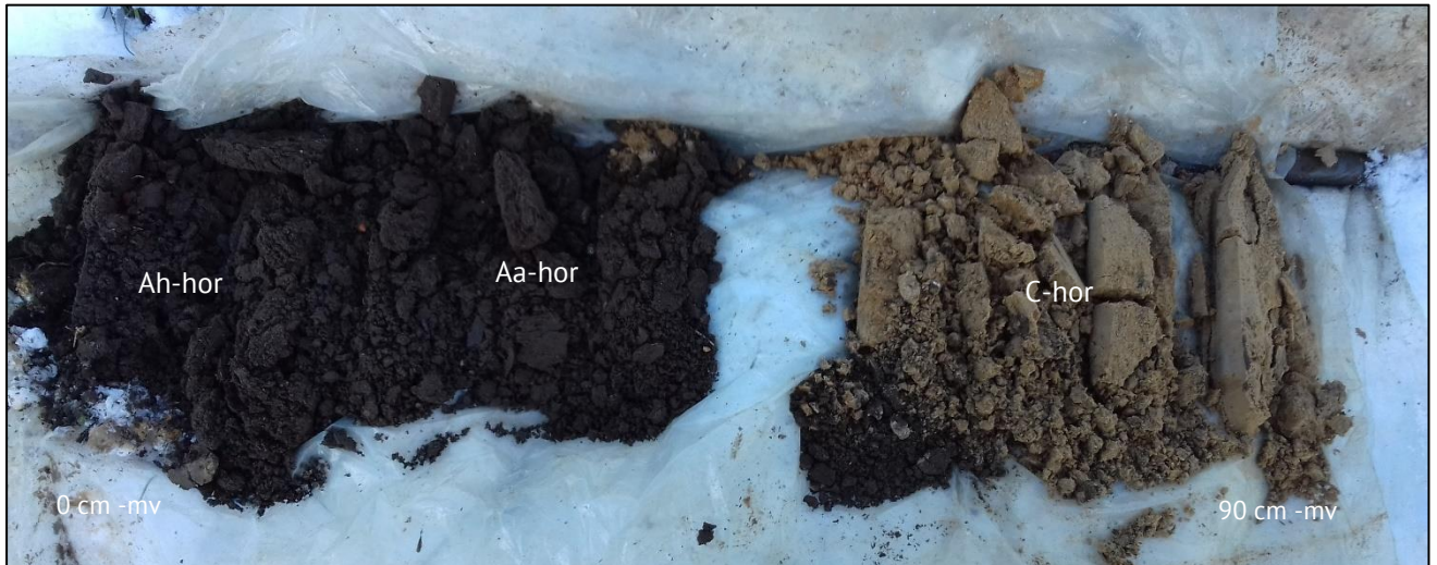
Figuur 7. Boorprofiel van boring 4 (0 – 90 centimeter onder maaiveld). Leesrichting is van links naar recht. (Foto: 25 januari 2021).
