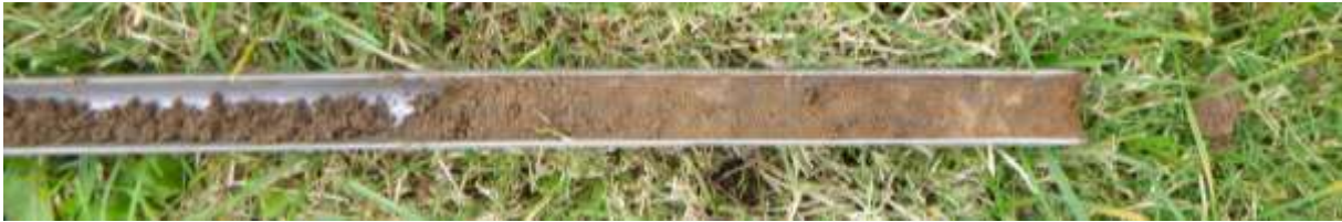
Figuur 23: Foto van de vergraven tussenlaag zoals deze op de boorpunten 1, 4, 5, 6, 9 en 10 is aangetroffen.
