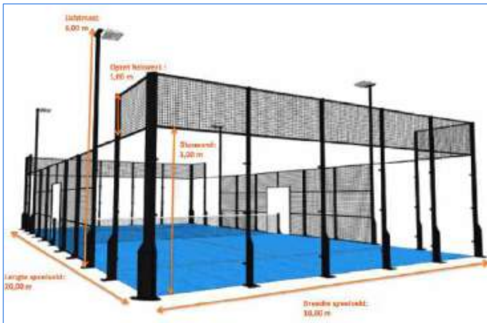
Afbeelding 5 Voorgescreven afmetingen padelbaan
