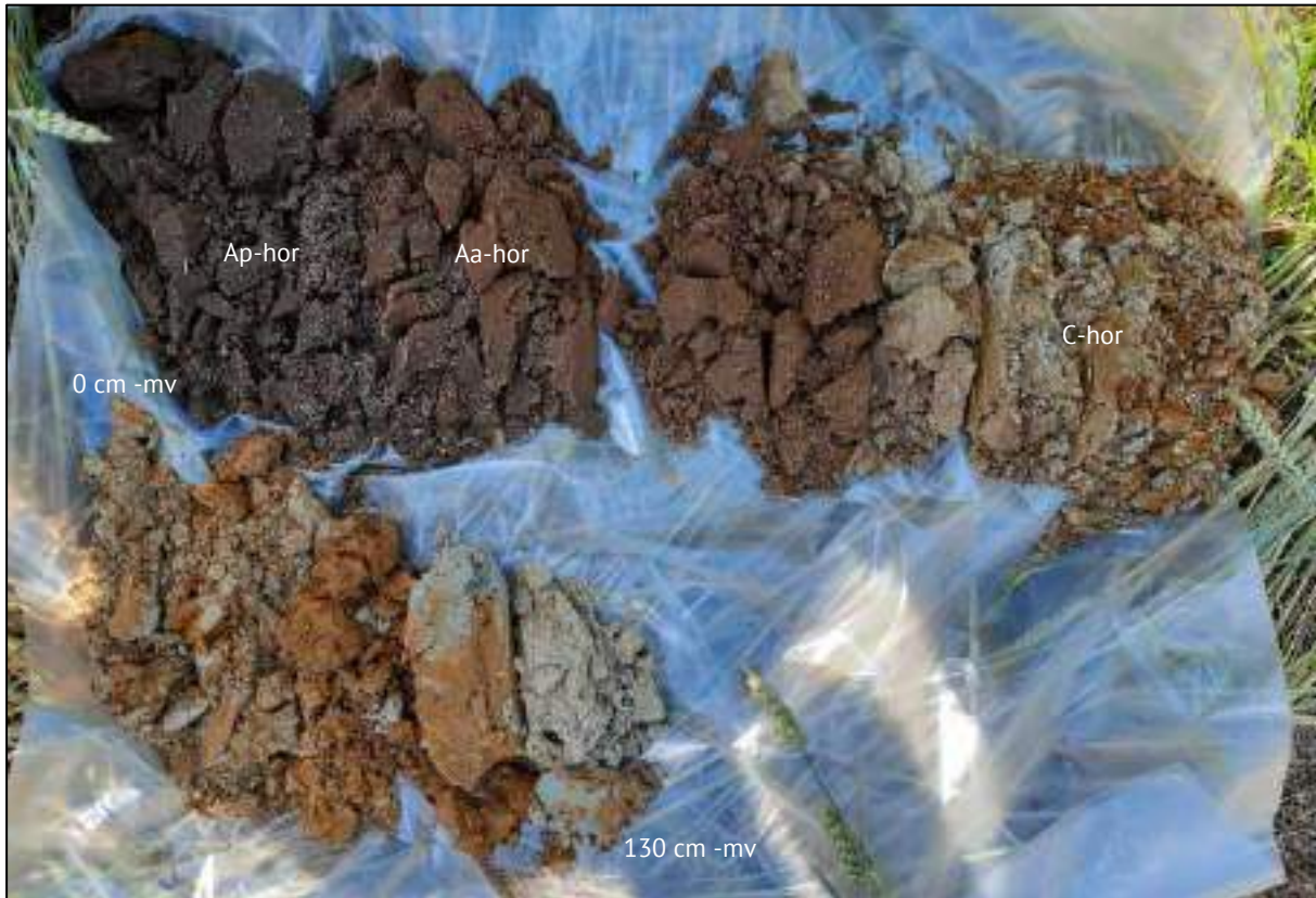
Figuur 8: Foto van boorprofiel boring 9 van de bovenste 130 centimeter. Leesrichting is van links naar rechts.
