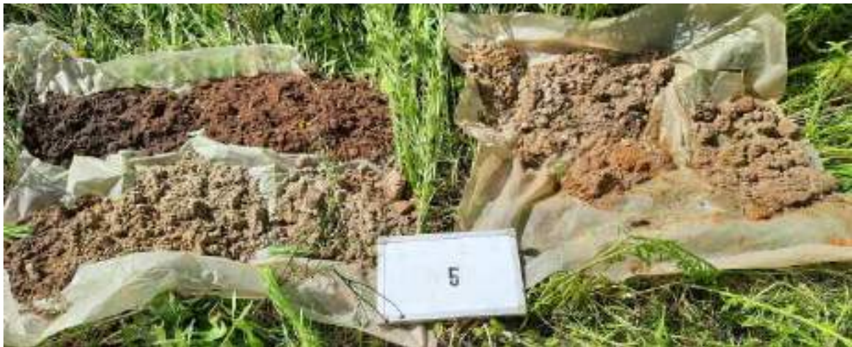
Afbeelding 5: Foto boorprofiel boring 5; leesrichting van linksboven naar rechtsonder
