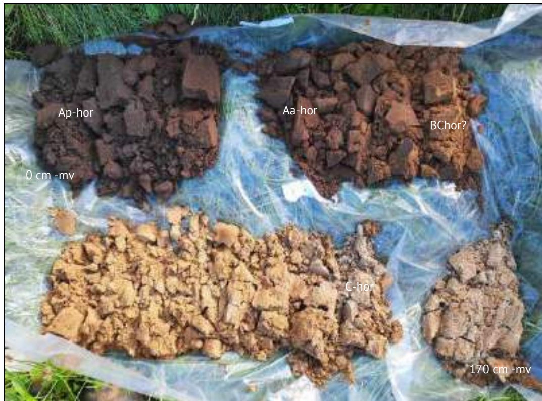
Figuur 7: Foto van boorprofiel boring 1. Leesrichting is van links naar rechts (0 – 170 centimeter).
