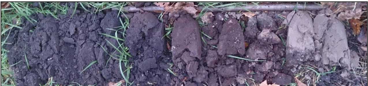
Figuur 5: boorprofiel van boring 4.
